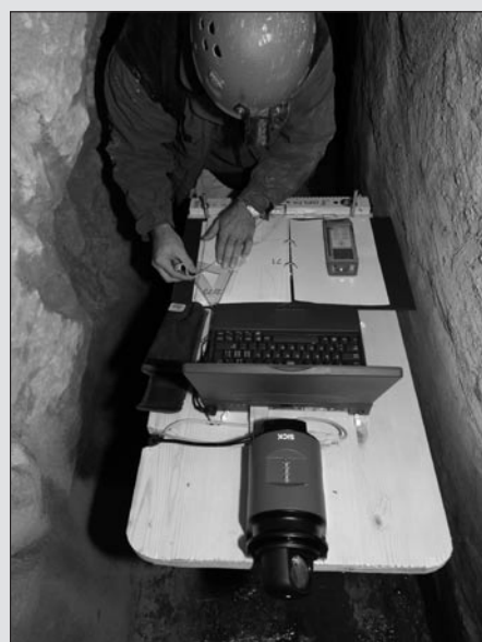
Vermessung des über 2 km langen, am Ende des 19. Jahrhunderts ausgebrochenen Wasserstollens von Valangin mit Hilfe eines 2D-Scanners.
