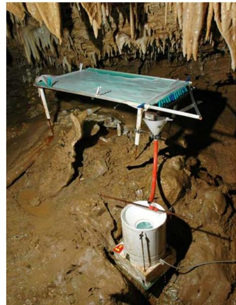
Installation zur Schüttungsmessung der Tropfsteine für den Test des Einspeisesystems, das entwickelt wurde, um den Einfluss der Autobahn zu minimieren.
