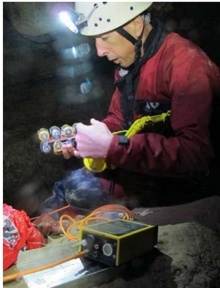
Batteriewechsel im Rahmen einer Begehung zum Unterhalt der Geräte.
