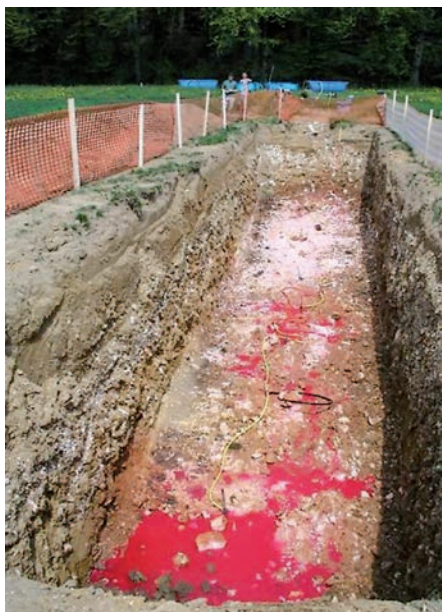
Tracer-Tests in offenem und bedecktem Karst: links bewegt sich der Farbstoff mehrere Kilometer pro Tag; rechts brauchte der Tracer mehr als 5 Jahre, um die Höhle in 50 Metern Tiefe zu erreichen!
