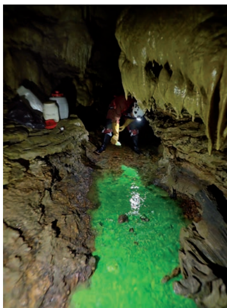
Tracer-Tests in offenem und bedecktem Karst: links bewegt sich der Farbstoff mehrere Kilometer pro Tag; rechts brauchte der Tracer mehr als 5 Jahre, um die Höhle in 50 Metern Tiefe zu erreichen!
