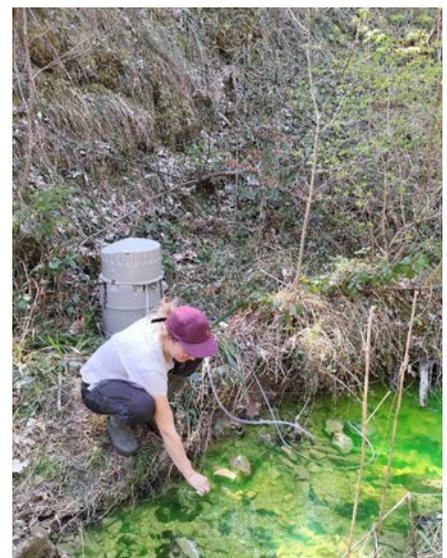
Ein farbiger Tracer wird zur Bestimmung von Quellen in Verbindung mit einem verschmutzten Standort verwendet.
