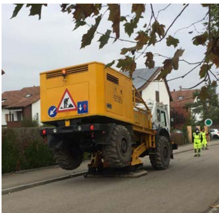
Rüttel-LKW für seismische Messungen in MuttENZ.
