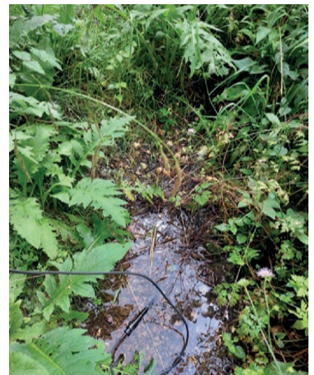
Messung von Temperatur, Leitfähigkeit und Schätzung der Durchflussmenge einer Quellgruppe in Balsthal.
