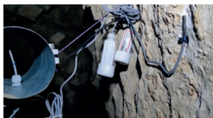
Figur 6: Messungen der Luft- und Gesteinstemperatur. Die Sonde im Inneren des Rohrs ist abgeschirmt, um nur die Lufttemperatur zu messen und zu verhindern, dass sie von der Wandtemperatur (durch Wärmestrahlung) beeinflusst wird. Auf der rechten Seite ist die Sonde an die Wand geklebt. Die weissen Zylinder messen Temperaturen, die zwischen der Wand- und der Lufttemperatur liegen.
