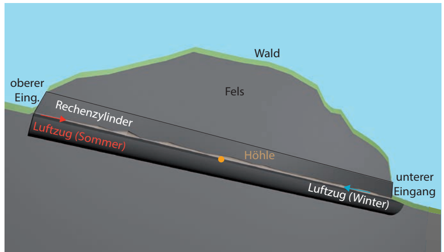
Figur 8: Schematisches Profil der Baume de Longeigue, vereinfacht für die Wärmeberechnung. Die Höhle wird von einem Luftzug durchströmt, der je nach Jahreszeit der Richtung wechselt. Für die Berechnung wird die Höhle in einen Zylinder mit einem Durchmesser von 20 m eingeschlossen, um den herum die Bedingungen durch die Temperatur des Gebirges unter der Oberfläche festgelegt werden. Die Temperatur der in die Höhle einströmenden Luft variiert je nach der ausserhalb der Höhle gemessenen Temperatur. Der orangefarbene Punkt markiert die Position der in der nächsten Abbildung simulierten Messstation.
