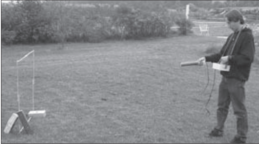
Die Positionierstation bei einem Test im Freien. Das Sendersignal kann bis zu 200 m durch den Felsen empfangen werden.
