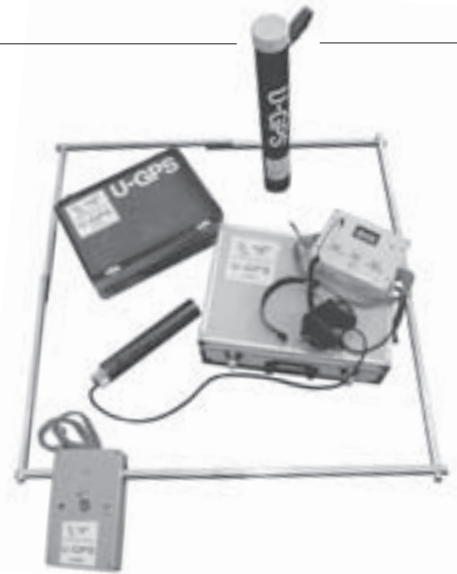
Die U-GPS Positionierstation mit ihrer 1 m 2 Antenne.
