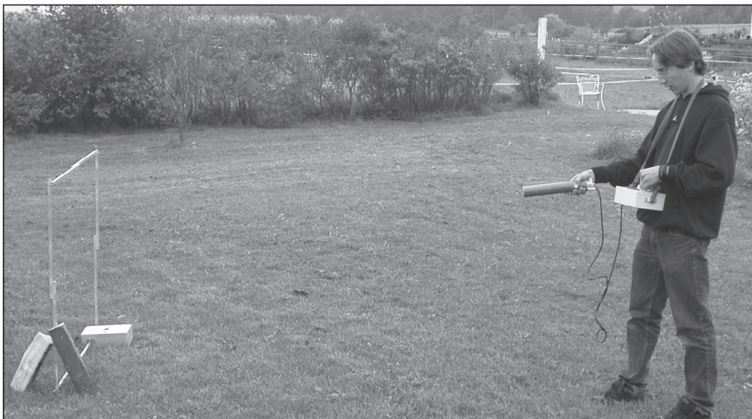
La balise de positionnement lors d'un test à l'extérieur. Le signal de l'émetteur peut être capté jusqu'à une distance de 200 m au travers de la roche.
