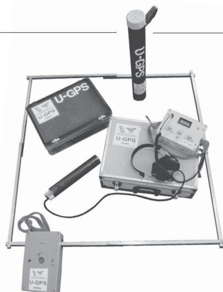
La balise de positionnement U-GPS avec son antenne carrée de 1 m de côté.
