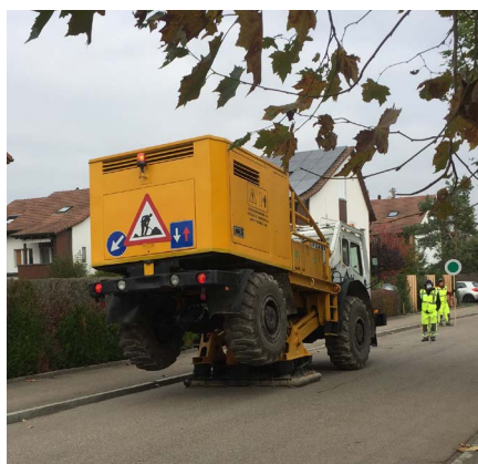
Camion vibreur pour mesures sismiques à MuttENZ.
