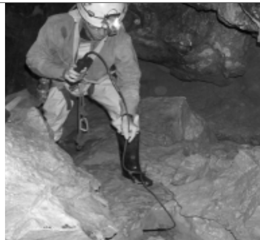
Mesure de la qualité de l'eau dans le réseau souterrain de Covatannaz au moyen d'un conductimètre.
