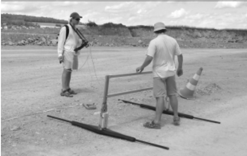
Mesures électromagnétiques au moyen du géoradar sur le tracé de l'autoroute A16, à proximité de Porrentruy.
